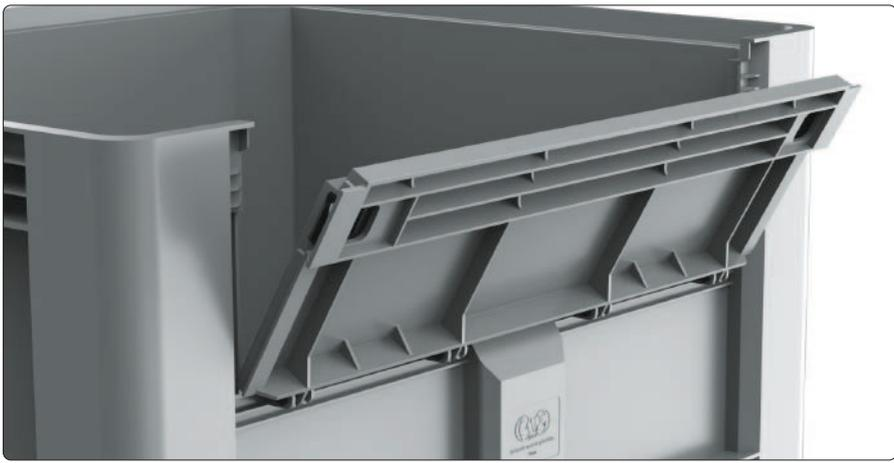
“1089 CA” et “1091 CA” avec leur grande paroi rabattable frontale (produite directement dans la machine) facilitent la collecte ou l’introduction des composants en cours de traitement, accélèrent leur stockage ou l’alimentation des machines sur les lignes d’usinage; alignés et superposés, ils remplacent les rayonnages traditionnels. Ils constituent aussi un support d’exposition pratique et fonctionnel pour les produits de consommation destinés à la vente dans les grands surface.
